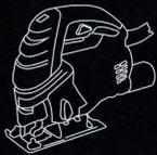
Usando la sierra caladora Bauker, cortar placa MDF dimensionada y perforar con broca de 8mm de diámetro para colocar tarugos de madera, uniéndolos con cola fría extrafuerte.
