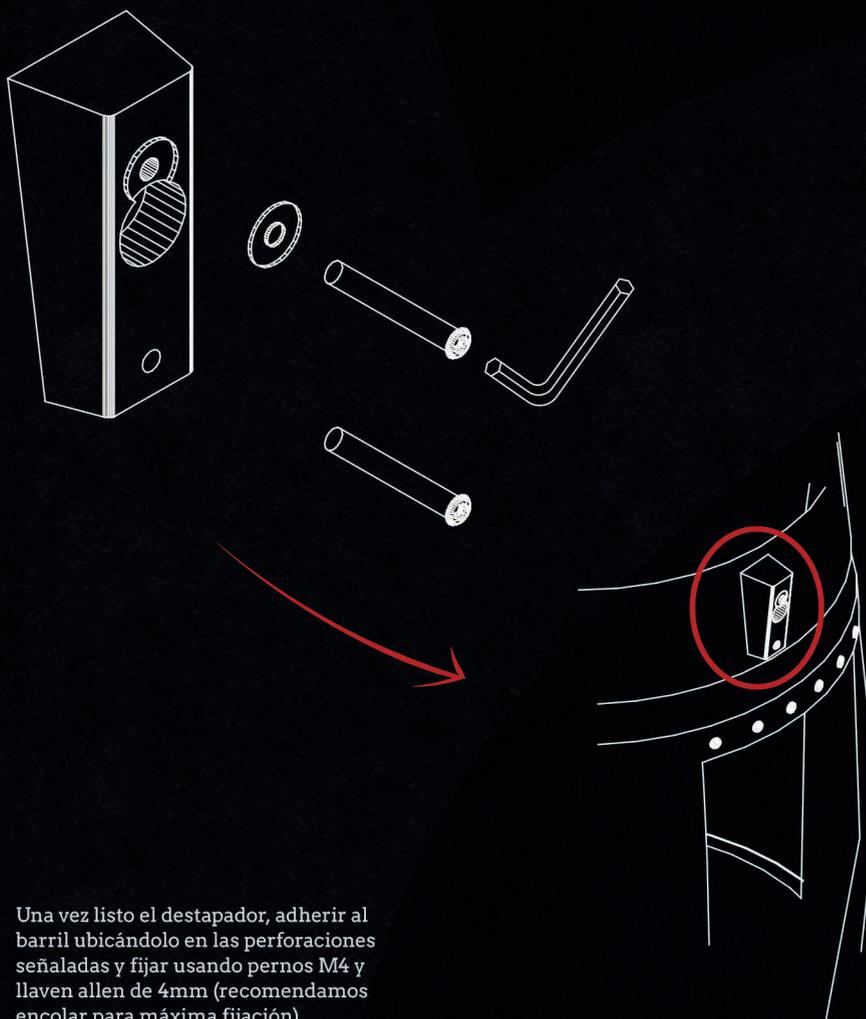
Una vez listo el destapador, adherir al barril ubicándolo en las perforaciones señaladas y fijar usando pernos M4 y llaves allen de 4mm (recomendamos encolar para máxima fijación)
