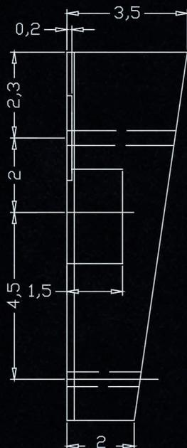
Luego perforar la pieza creada en dos puntos con una broca de 3.5mm de diámetro, atravesando la pieza para pasar tornillos y afirmar el barril.
