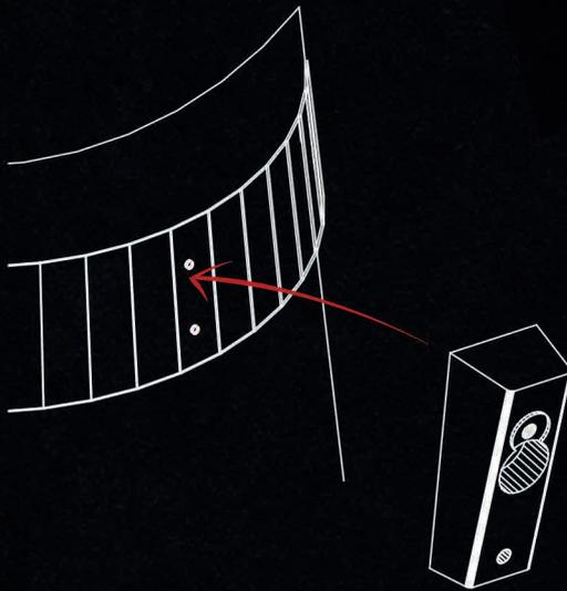
Sujeción: perforar dos puntos en la zona superior del barril con broca para metal de 3.5mm de diámetro para instalar destapador.
